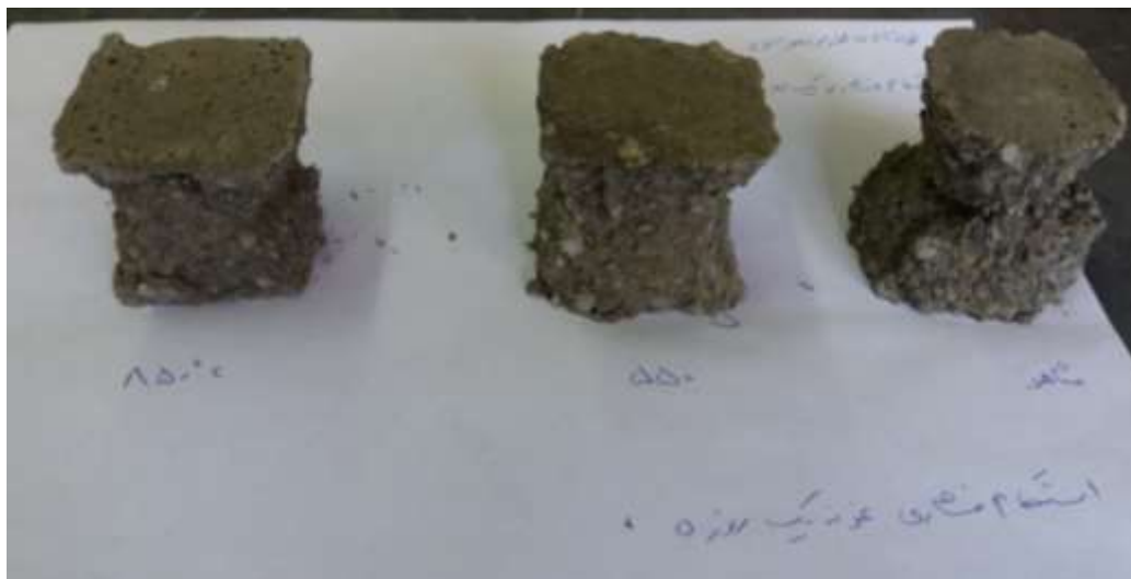
شکل (۴-۵): شمایی از نمونه اکتیو شده واوند در دو دما و شاهد پس از تست استحکام فشاری یک روزه
