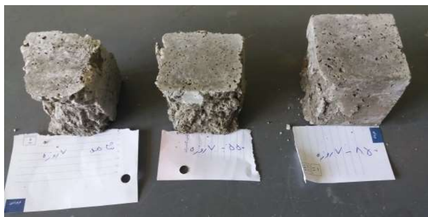
شکل (۵-۵): شمایی از نمونه اکتیو شده واوند در دو دما و شاهد پس از تست استحکام فشاری هفت روزه
