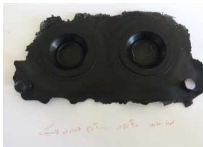
شکل (۳-۵): نمونه لاستیک تزریق شده با ۲۸/۵ درصد خاک معدن واوند فرآوری شده
