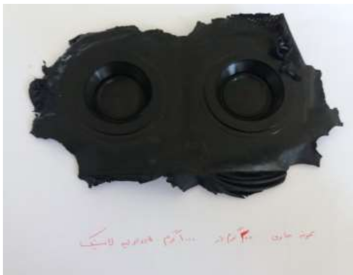
شکل (۲-۵): نمونه لاستیک تزریق شده با ۱۶/۵ درصد خاک معدن واوند فرآوری شده
